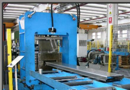
Dettaglio pressa di taglio idraulica
