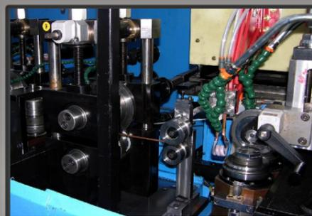
Dettaglio testa di saldatura
