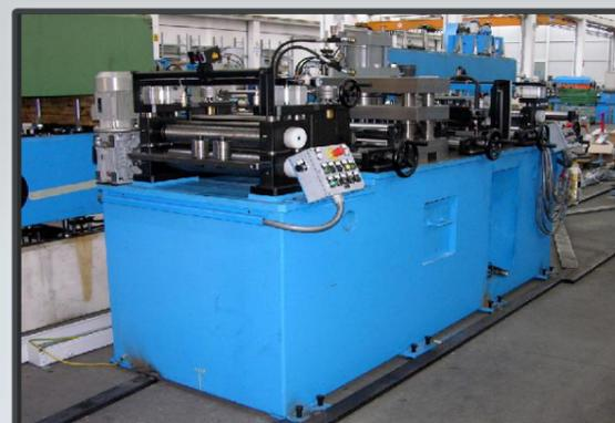
Banco di intestatura e saldatura di testa
