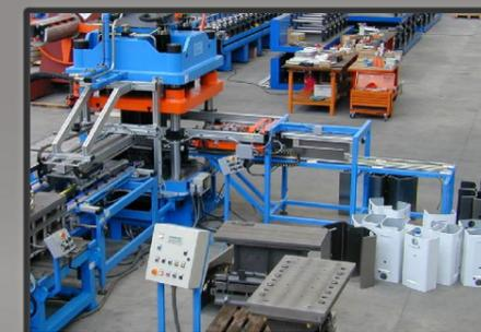
Dettaglio pressa idraulica e rulliera di scarico
