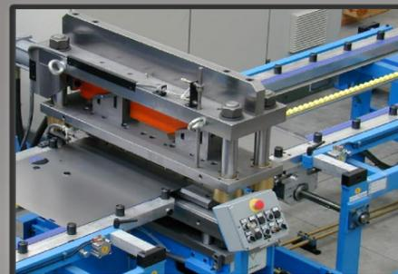
Head-tail cutting-bending die
