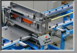
Head-tail cutting-bending die
